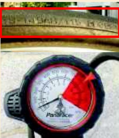
タイヤには適正空気圧が刻印されているので確認して正確に入れる。タイヤの種類により違いがある。
